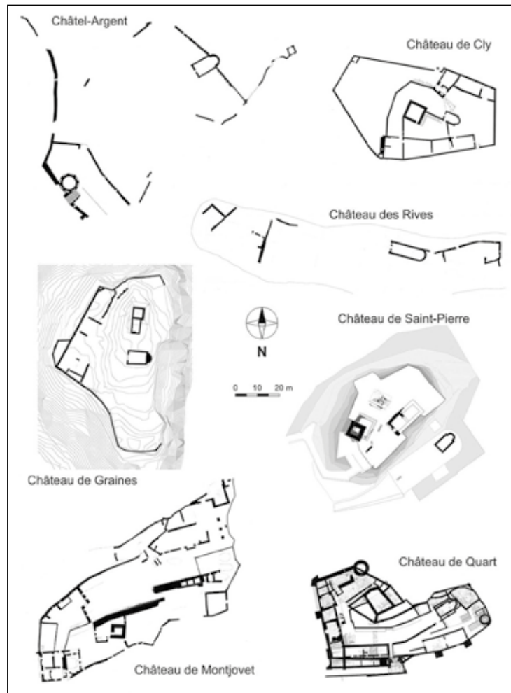
Fig. 5 - Pianta dell'odierna situazione planimetrica di castelli valdostani all'interno delle quali si riconosce l'impianto tipico dei "castelli recinto" o "castelli rifugio" (elaborazione dell'autore).
